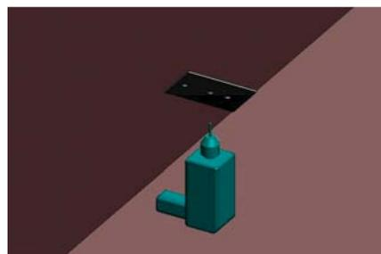
6. INSERIRE ACCESSORI PINZA SENZA COPERCHI (2x OGNI VETRO FISSO - 4x OGNI SOPRALUCE PORTA SINGOLA - 8x OGNI SOPRALUCE PORTA DOPPIA) IN POSIZIONE COME FIG. C ED AVVITARE IL GRANO (NON A PACCO) IN MODO DA PERMETTERE L'OSCILLAZIONE DELLA PINZA
